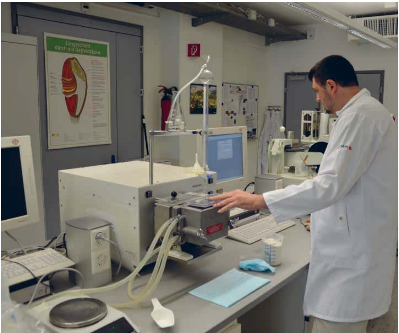
Nel laboratorio della qualità della Jowa AG sono rilevati 17 diversi parametri di qualità delle farine. Oltre al tenore di glutine umido sono di grande importanza anche la qualità del glutine umido, l'attività enzimatica e l'elasticità della pasta.
