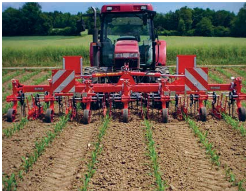
Sarchiatrice (montatura frontale) nel granoturco: uno dei macchinari dimostrati
