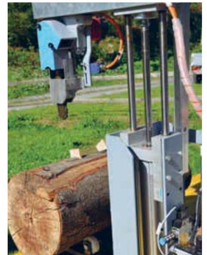
Per l'inoculazione del micelio nei tronchi Allenbach e Burkhalter hanno sviluppato una macchina speciale.
