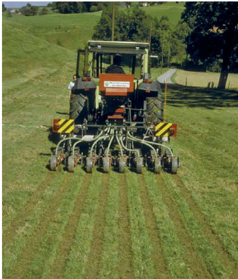
Il Vakutec Slotter fresa il prato e depone la semente attraverso una seminatrice pneumatica. I rulli pneumatici comprimono le strisce con la semente.
