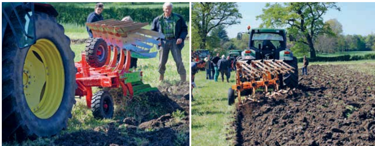
Un aratro per aratura di superficie della marca spagnola Escudero (a sinistra) e un classico aratro a stegola con profondità di lavorazione ridotta grazie a una ruota di sostegno.
