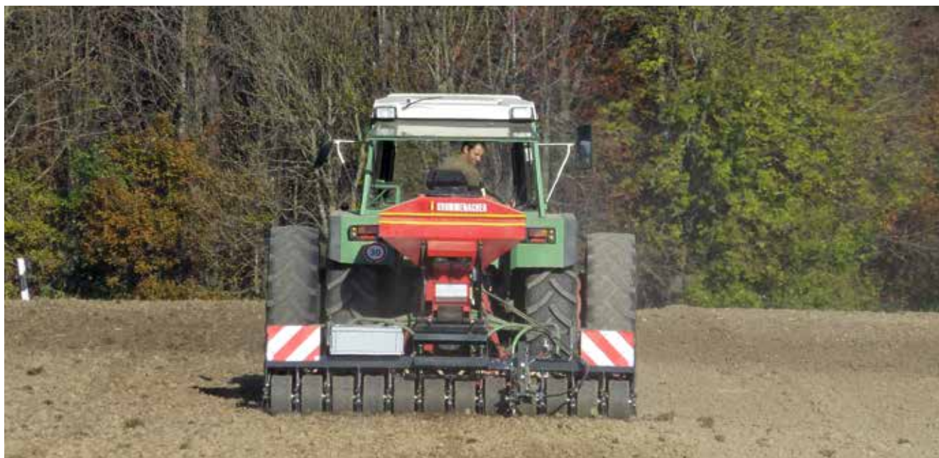
Urs Knecht semina il frumento con una combinazione di erpice rotativo e un rullo Krummenacher. Entrambi gli attrezzi sono molto leggeri e ciò gli permette di usare la combinazione anche con il suo trattore da 85 CV. Foto: Strickhhof
