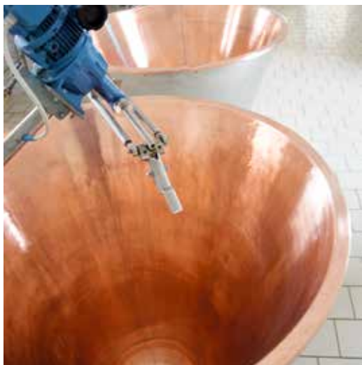
Le caldaie coniche in rame da 990 litri sono tipiche per la produzione di Parmigiano. Fotografie: Franziska Hämmerli
