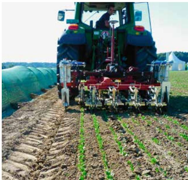
Sistema satellitare con coltro a dischi. Foto: Lenzberg.ch
