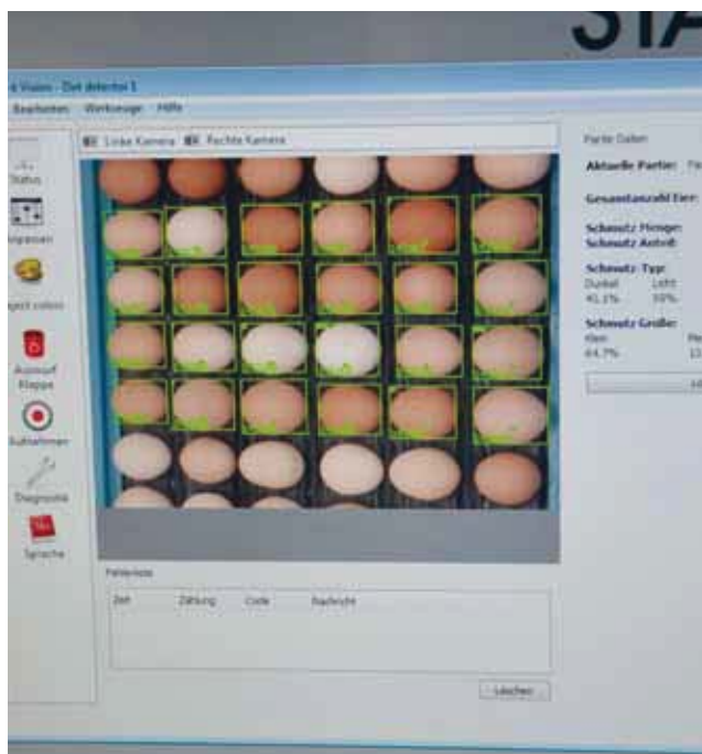
L'impianto è in grado di selezionare assieme uova brune e uova bianche. Lo scanner lascia passare solo merce pulita.
