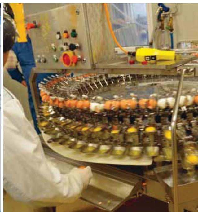
Le uova industriali sono rotte e separate automaticamente. Ne risultano uova liquide per la trasformazione di alimenti.
