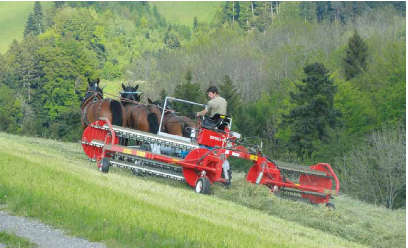
David Michel con il suo ranghinatore: l'attrezzo viene azionato attraverso le ruote dell'avantreno e una pompa idraulica
