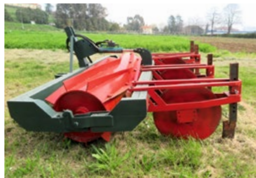
Prototipo di un rullo a lame che pratica incisioni.
