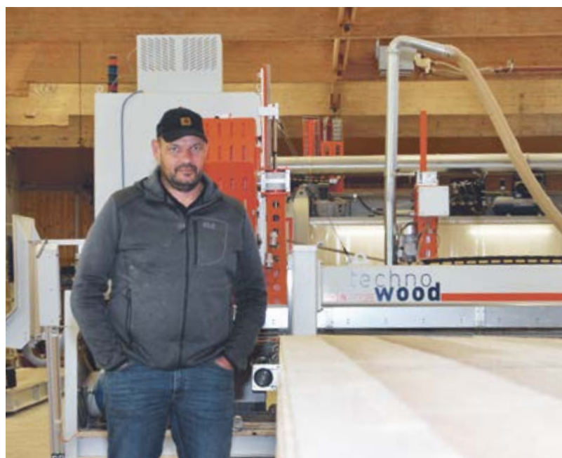
Jürg Hirschi davanti all'impianto di produzione che intassella pannelli di compensato spessi fino a 24 centimetri. Foto: Stephan Jaun
