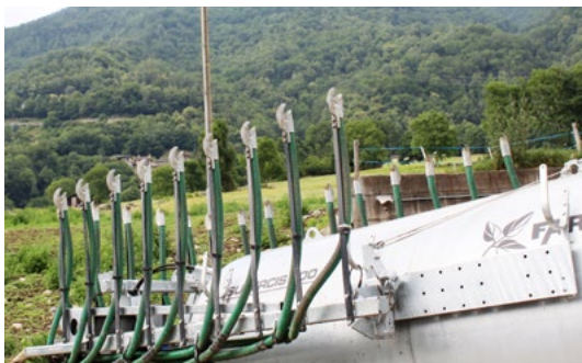
Un dettaglio del macchinario per lo spandimento a basse emissioni.
