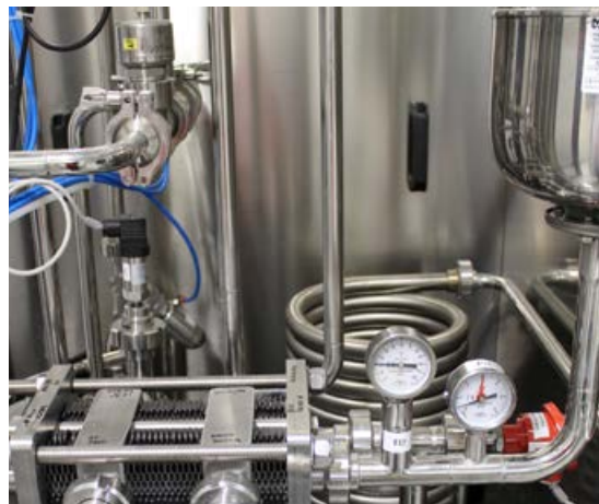
Il cuore dell'impianto di pastorizzazione, dove il latte viene riscaldato a 74°C per 15 secondi.
