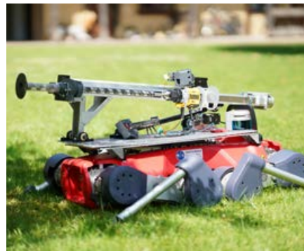
Il robot quadrupede preleva e analizza campioni di terreno sul posto.
