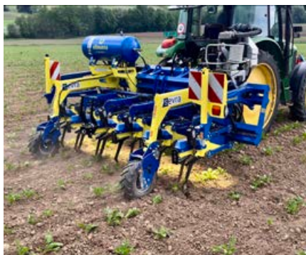
Le sarchiatrici interfilari sostituiscono il lavoro manuale nelle file.
